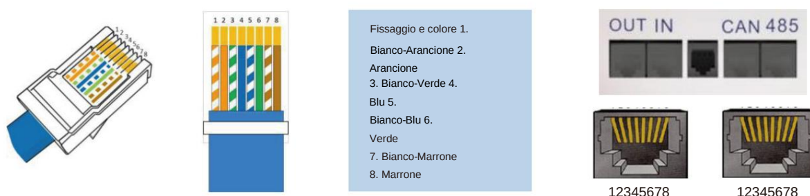
Figura 2-2 Definizione dell'interfaccia CAN, RS485, OUT, IN
