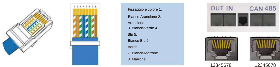
Figura 2-2 Definizione dell'interfaccia CAN, RS485, OUT, IN
