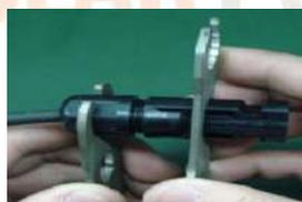
**Passaggio 4:** Controllare che la polarità del cavo di collegamento dai moduli FV e dai connettori in ingresso FV sia corretta. Collegare poi il polo positivo (+) del cavo di collegamento al polo positivo (+) del connettore di ingresso FV. Collegare poi il polo positivo (-) del cavo di collegamento al polo negativo (-) del connettore di ingresso FV.
