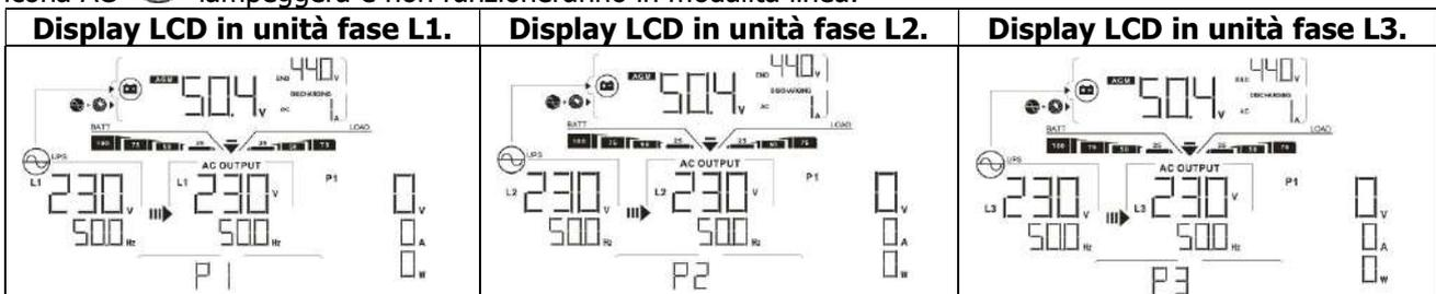
Passaggio 5: Se non ci sono allarmi di errore, il sistema per supportare le apparecchiature trifase è installato in modo completo.
