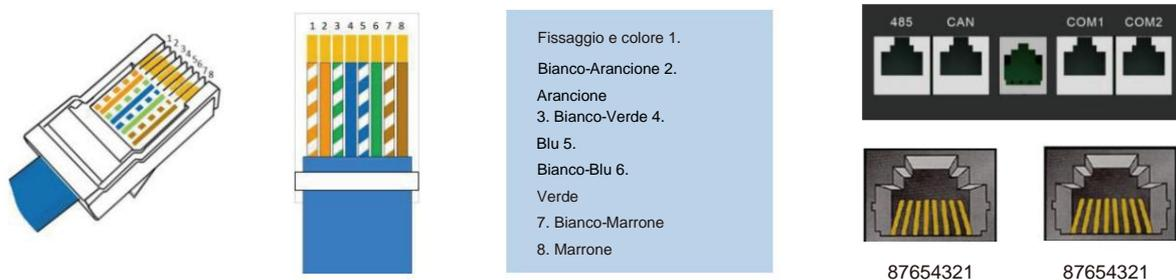
Figura 2-2 Definizione dell'interfaccia CAN, RS485, COM1, COM2
