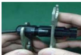
**Passaggio 4 :** verificare la corretta polarità del cavo di collegamento dai moduli FV e dai connettori di ingresso FV. Quindi, collegare il polo positivo (+) del cavo di collegamento al polo positivo (+) del connettore di ingresso FV. Collegare il polo negativo (-) del cavo di collegamento al polo negativo (-) del connettore di ingresso FV.
