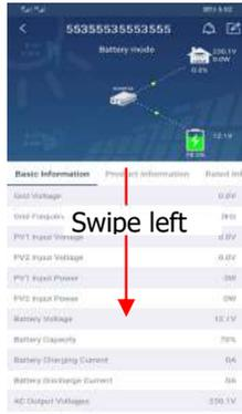
【Grundlegende Informationen】 zeigt grundlegende Informationen des Wechselrichters an, einschließlich AC-Spannung, AC-Frequenz, PV-Eingangsspannung, Batteriespannung, Batteriekapazität, Ladestrom, Entladestrom, Ausgangsspannung, Ausgangsfrequenz, Ausgangsscheinleistung, Ausgangswirkleistung und Lastprozent . Bitte nach oben schieben, um weitere grundlegende Informationen anzuzeigen.
